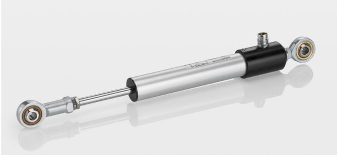
这款传感器具有防护等级高、结构紧凑和价格低廉的特点。金属法兰和双密封拉杆设计，坚固耐用，在脏、尘、湿、潮等极端恶劣环境下能可靠工作。侧向力缓冲万向球眼接头极大方便客户安装，特别适合工程机械类应用。传感器电气连接可选择径向接头或径向电缆。
